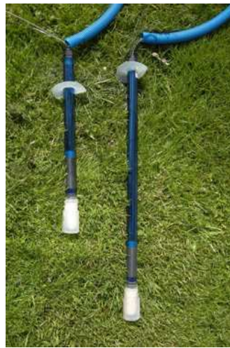
Tensiometri in dotazione presso le due stazioni di misura dell'Osservatorio per l'umidità del suolo
