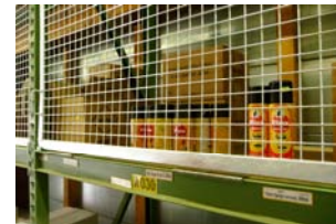
Stoccare gli imballaggi di gas compressi lontano dalle finestre e preferibilmente dietro una griglia.
