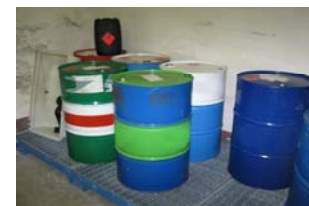
... a partire da 450 litri è necessario un locale separato con compartimentazioni tagliafuoco (e aerazione).
