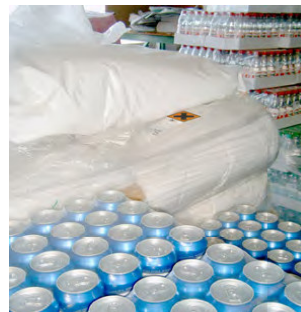
Errato! Derrate alimentari e sostanze pericolose vanno stoccate separatamente.
