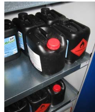
I liquidi infiammabili devono essere stoccati in un armadio non infiammabile con vasca di contenimento; ...
