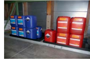
Nel caso di pavimenti in calcestruzzo, vanno stoccati in vasche di contenimento resistenti perlomeno agli acidi.
