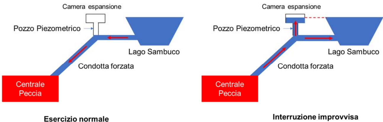
Figura 14: Funzionamento del pozzo piezometrico
