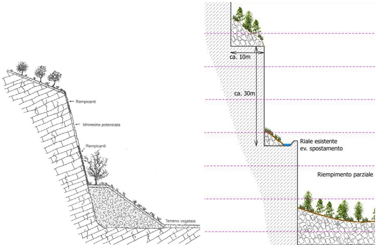
Figure 3: riporto del materiale di scarto della lavorazione alla base delle pareti rocciose[d], risp., dei gradoni.
