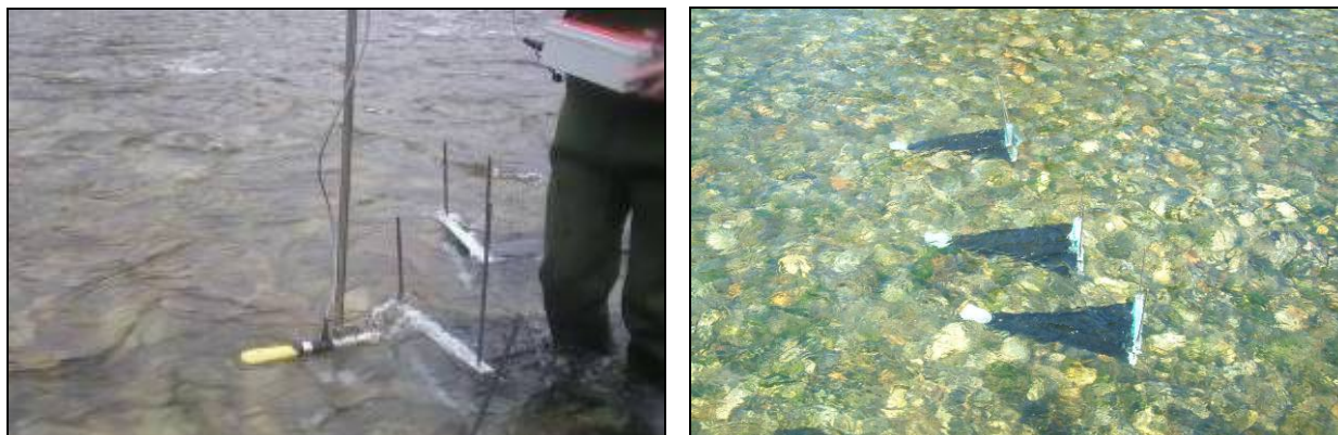
Figura 32: Campionamento del drift durante la fase I, con reti da 500 µm e correntimetro a induzione magnetica.
