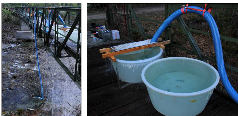
Figura 33: Campionamento del drift durante la fase II. Stazione di pompaggio e filtrazione con reti da 100 µm a Pollegio.
