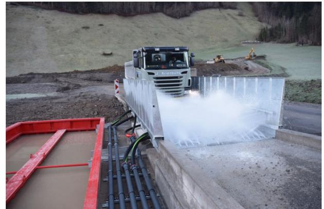
Esempi di impianti di lavaggio ruote dotati di getti a pressione (fonte: web).
