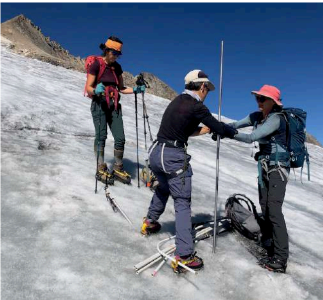
Fig. 6. Trivella da 3 m in azione. Dall'inizio degli anni '90 viene utilizzata una "vite da ghiaccio" di questo tipo. Denti della corona affilati e forza di braccia sono essenziali. "Womanpower" in azione il 13.7.2022.
