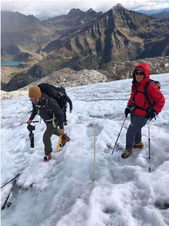
Fig. 18 e 19. L'ultima delle 5 uscite dell'estate 2022. Senza trivella, si tartta di fare l'ultimo rilevamento delle 10 paline. È il 16 settembre e la palina nr 10 rimessa a zero il 20 agosto sporge di circa un metro. Un metro di ghaiccio che se n'è andato in nemanco 4 settimane. Dunque da 3 a 5 cm al giorno di perdita di spessore. C'è anche la TSI che segue, ("Il giardino di Albert" del 22.10.22). La meteo sta già "cambiando" e all'indomani arriva la prima neve che finalmente blocca la fusione, per lasciar sul terreno i "duri segni di un'estae disastrosa".
