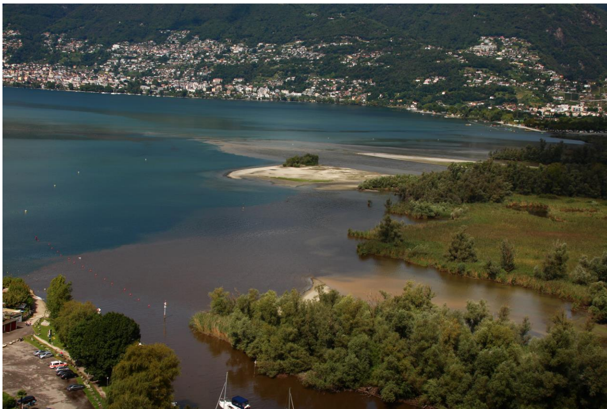
Esempio di piena di medie dimensioni avvenuta con lago basso. L'apporto di materiale dal fiume e dai canali del Piano è costituito da materiale fine, che una volta raggiunto il lago scende in profondità (densità e temperatura diversi tra acqua del lago e acqua del fiume e dei canali).
