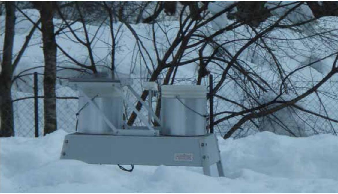
foto: campionatore utilizzato per raccogliere le deposizioni atmosferiche umide (pioggia, neve).
