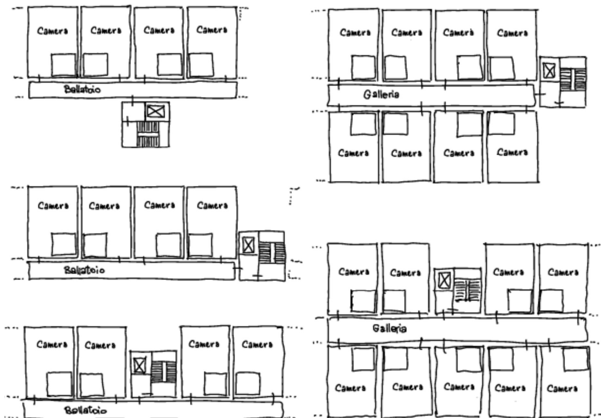
Figura 2.02 Tipologie a ballatoio o a galleria
