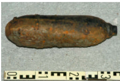
Foto dell'ordigno rinvenuto a Tenero, e riempito di sabbia, identificato in un proiettile per lanciamine ad aria compressa di fabbricazione tedesca in dotazione all'esercito svizzero dal mese di aprile 1917 al 1938.
