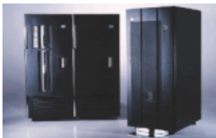
Sulla sinistra la nastroteca robotizzata IBM 3494 e a destra la componente VTS.
