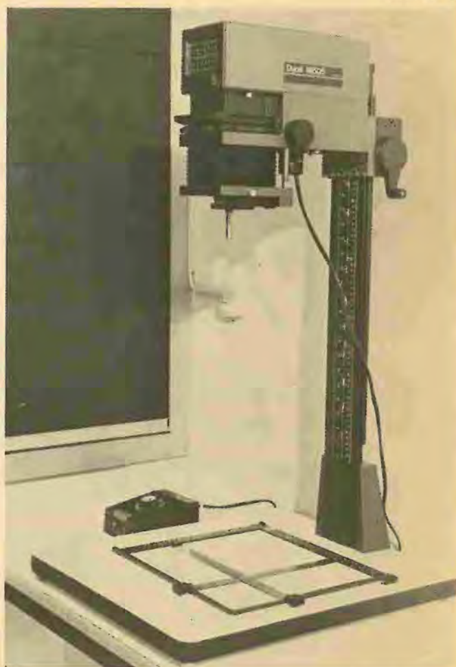
L'ingranditore in uso nelle nostre scuole insieme con il marginatore ed il «timer» (orologio temporizzatore).
