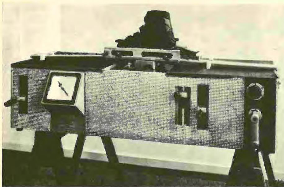
Fig. 7 - Apparecchio di collaudo dell'Ufficio svizzero per la prevenzione degli infortuni. Con questo apparecchio possono essere misurate esattamente la forza di scatto in caso di caduta frontale e i momenti di torsione che agiscono sul dispositivo di scatto laterale. Con ogni apparecchio di collaudo vengono consegnate norme di regolaggio allestite in collaborazione fra UPI e LEMEPUL e che hanno dato ottimi risultati già nel corso di due inverni.
