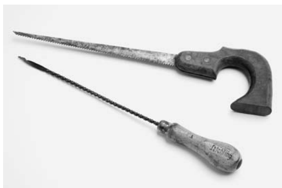
Fig. 113. Un gattuccio e, sotto, una lima da straforo (Collezione etnografica dello stato; fot. R. Pellegrini).
