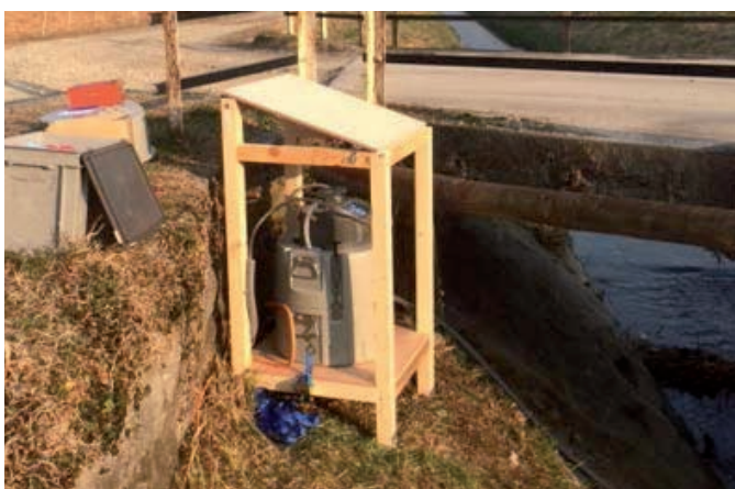
Figura 4: Campionatore automatico impiegato per l'indagine dell'Eawag sul canale del Piano di Magadino.
